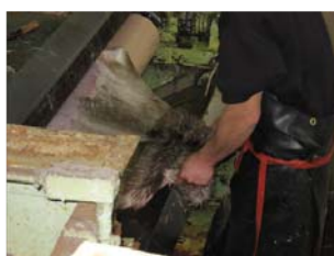
フレッシュングマシンで、エゾシカセームを作るうえで不必要な毛を取り除きます。
